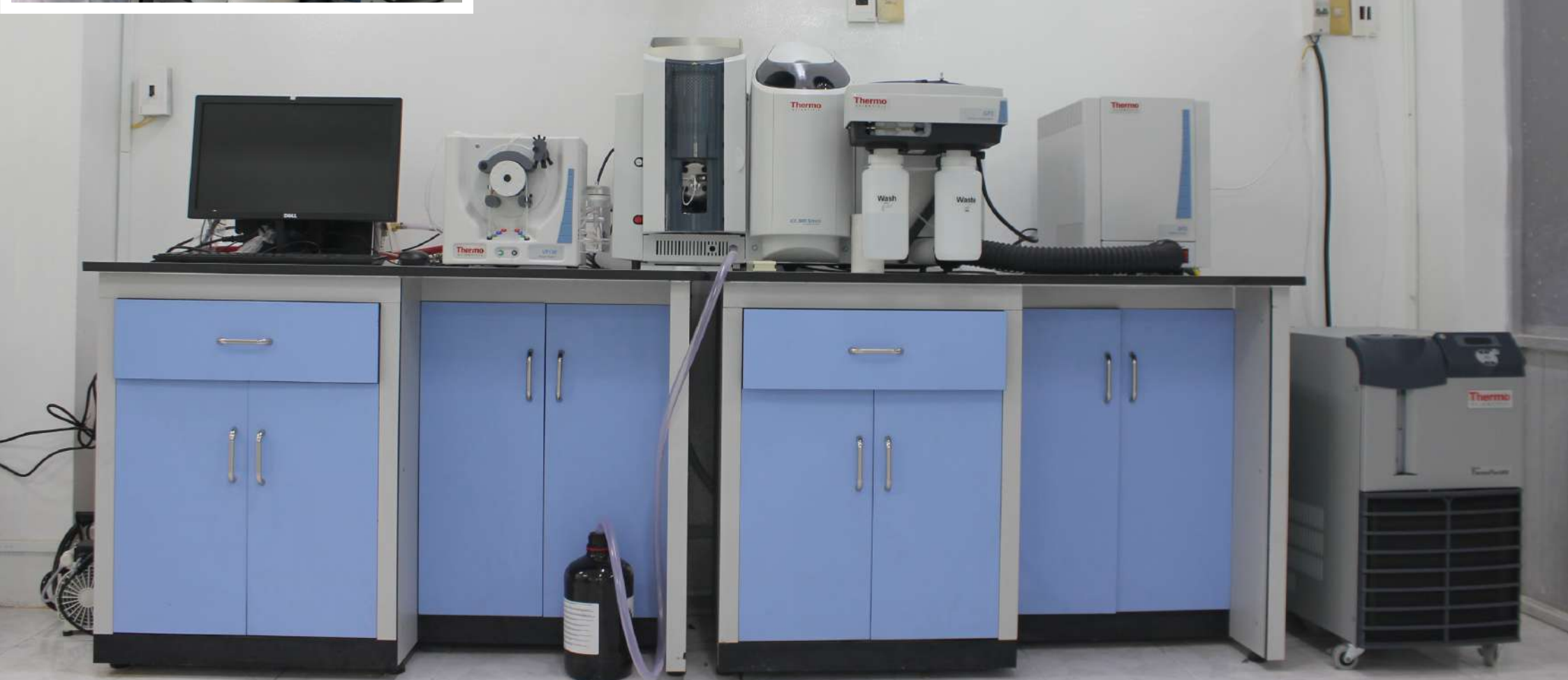
Hệ thống quang phổ hấp thụ nguyên tử lò graphit AAS/GF trong Phòng thí nghiệm
